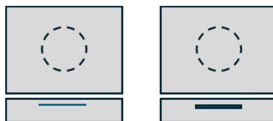
図－12 円形空洞、円形剥離欠陥
