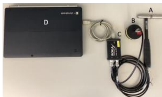
図－1 マルチ打音法における打音測定システム
