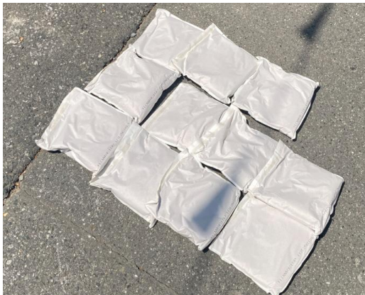
図-2 粉末パック型流動化剤フローリック LGP
