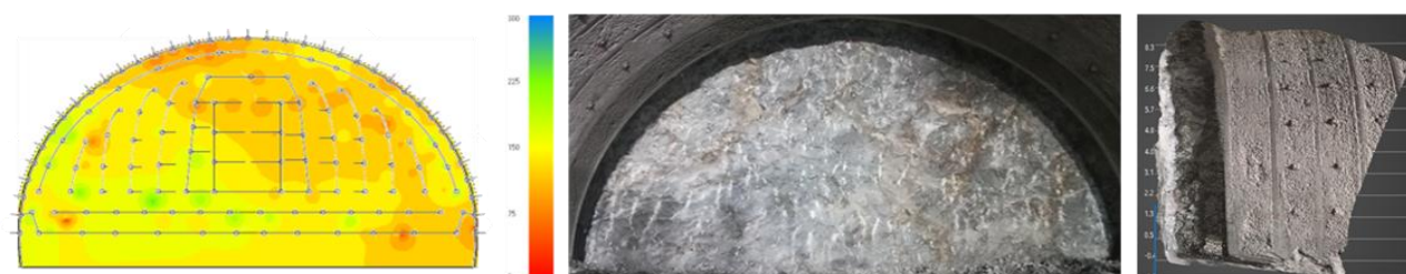
【2,3回目】 穿孔エネルギー：平均値123.9J/cm 3 (20.4~233.4J/cm 3 )，穿孔数：136孔，総装薬量：106.0kg
