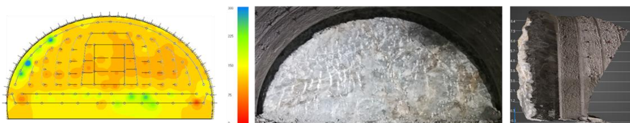
【4回目】 穿孔エネルギー：平均値123.6J/cm 3 (86.5~391.5J/cm 3 )，穿孔数：136孔，総装薬量：108.4kg
