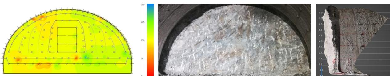
【1回目】 穿孔エネルギー：平均値162.2J/cm 3 (91.6~205.9J/cm 3 )，穿孔数：136孔，総装薬量：123.6kg
