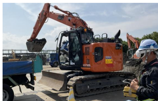
写真-10 HMDによる重機無線遠隔操作
