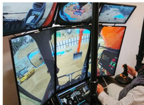
写真-2 従来型遠隔操作の例
