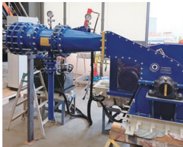
小水力発電所に有効なクロスフロー型水車
