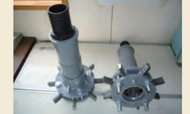
マイクロバブル渦崩壊洗浄装置
