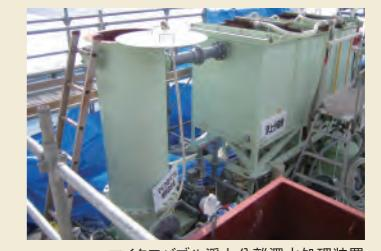
マイクロバブル浮上分離濁水処理装置
