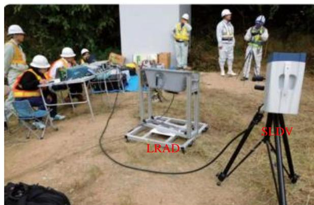
図-2 スキャン方式（SLDV と LRAD の組み合わせ）橋梁床版の測定事例<sup>7)</sup>
