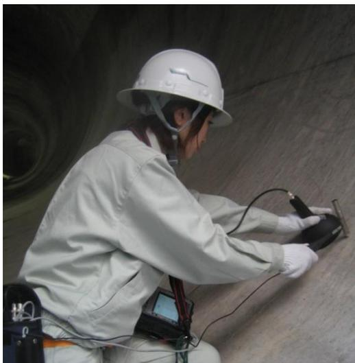
写真-2 健コン診断ポータブルの計測状況例
