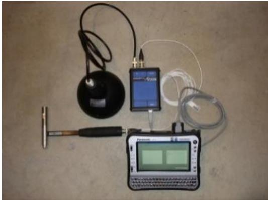
写真-1 健コン診断ポータブルの構成
