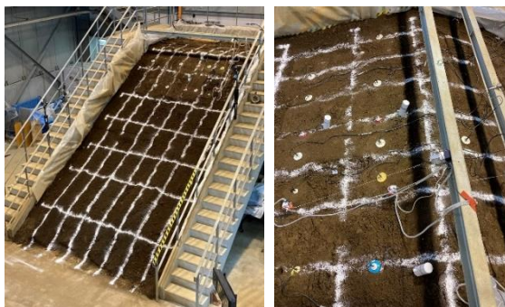
写真-1 実大斜面全景および計測箇所状況
