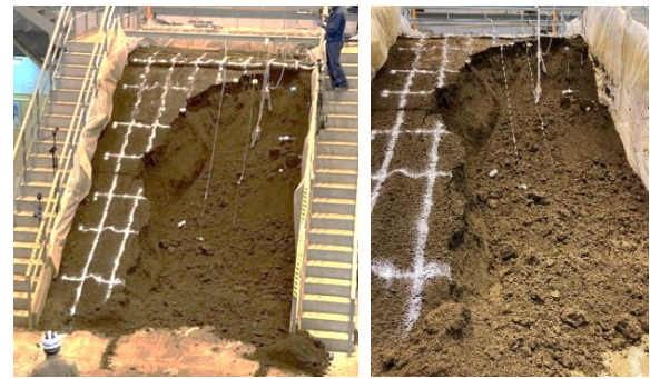
写真-3 実大斜面崩壊実験崩壊状況
