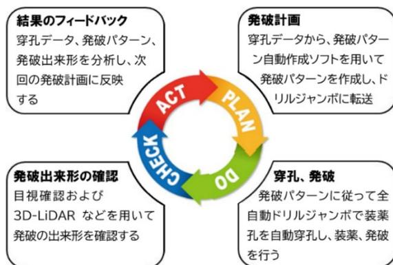
図-1 本システムにおける発破掘削フロー
