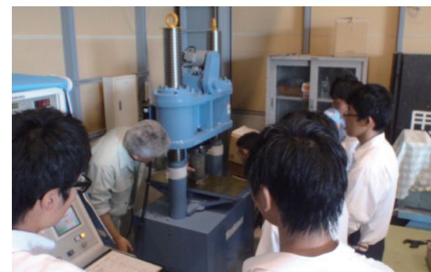
コンクリート強度試験の実施
