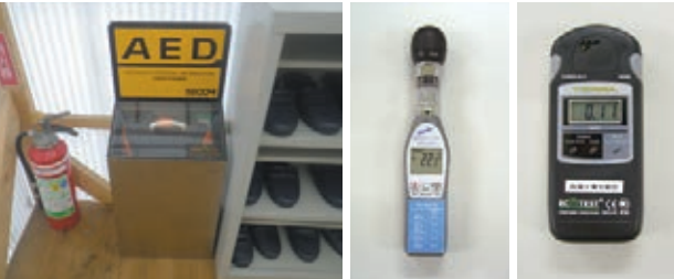
作業所AED設置状況 熱中症チェッカー ガイガーカウンター
