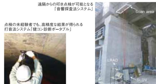
遠隔からの叩き点検が可能となる「音響探査法システム」
