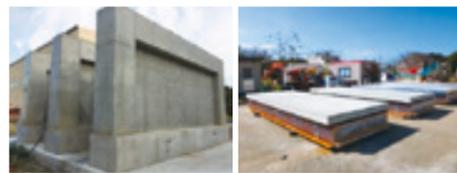
実大試験体(左:壁試験体 右:デッキスラブ試験体)
